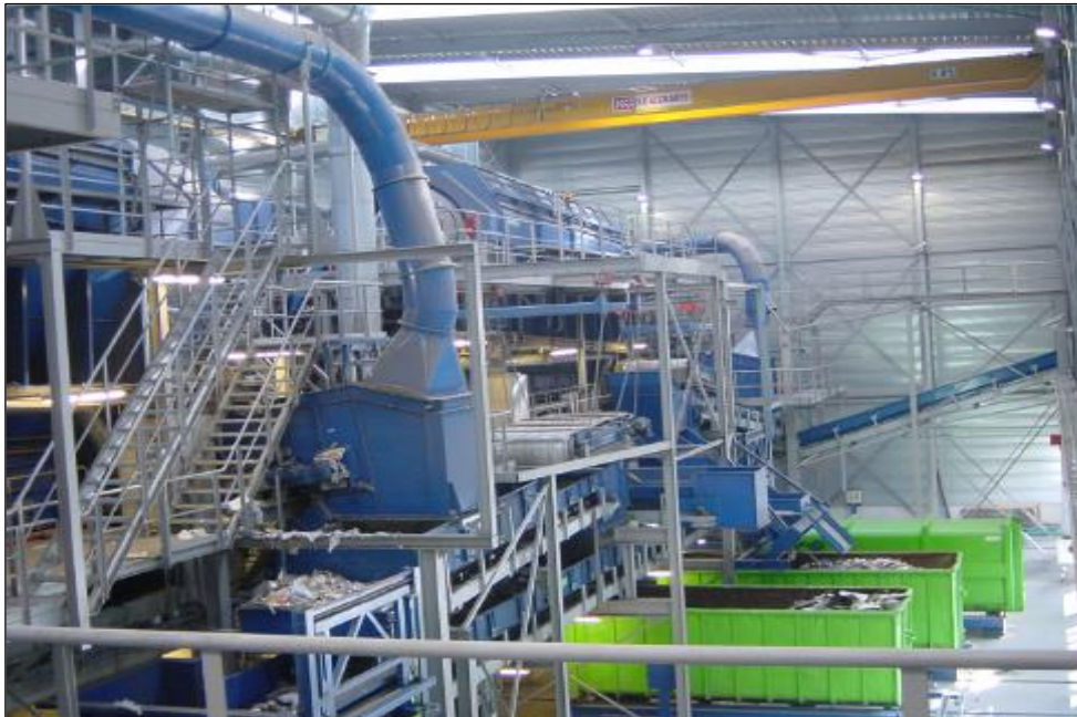
Slika 1.1-9: Dio postrojenja za mehaničku rafinaciju (proizvodnja gorive komponente otpada)
