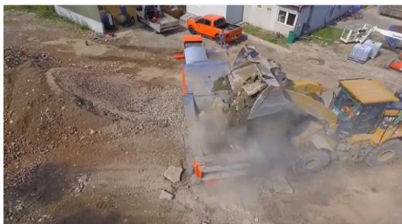
Slika 4.1-4: Emisije prašine višenamjenske drobilice materijala pri drobljenju građevinskog otpada Izvor: https://www.arjes.de/en/products/primary-shredder/impaktor-250-evo/
