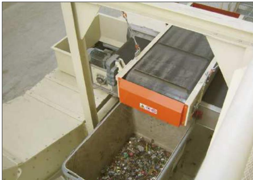
Slika 1.1-10: Dio postrojenja za mehaničku rafinaciju (separacija magnetskih metala)
