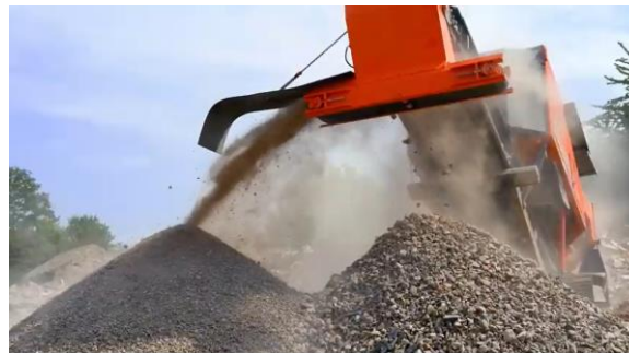
Slika 4.1-4: Emisije prašine višenamjenske drobilice materijala pri drobljenju građevinskog otpada Izvor: https://www.arjes.de/en/products/primary-shredder/impaktor-250-evo/
